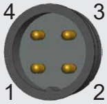
Pinbelegung für Sensoren mit Steckervariante (Draufsicht)
